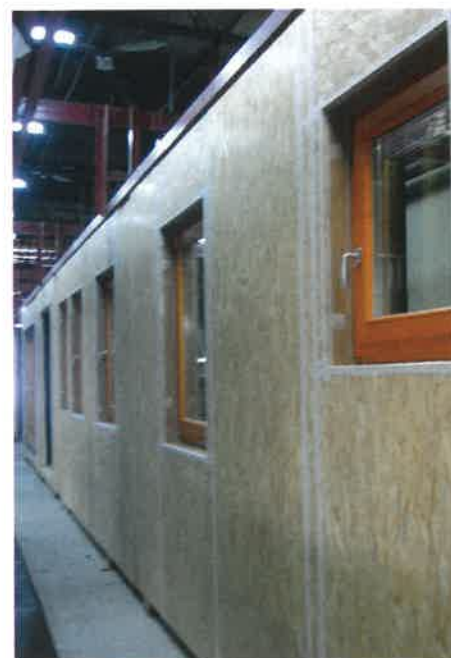
Slika 6: Zagotavljanje zrakotesnosti lesenih montažnih hiš v proizvodnem procesu.
