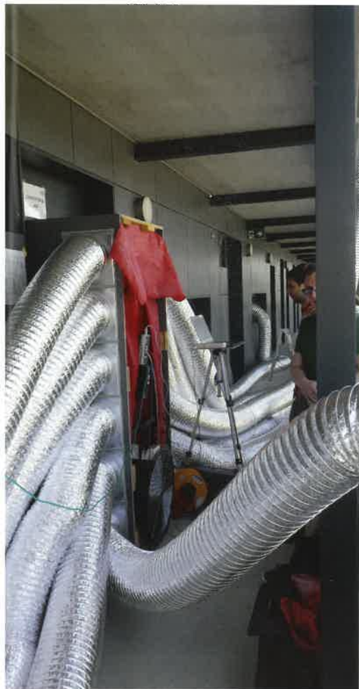
Meritev zrakotesnosti v večstanovanjski stavbi na Brdu v Ljubljani - vir: GI ZRMK
